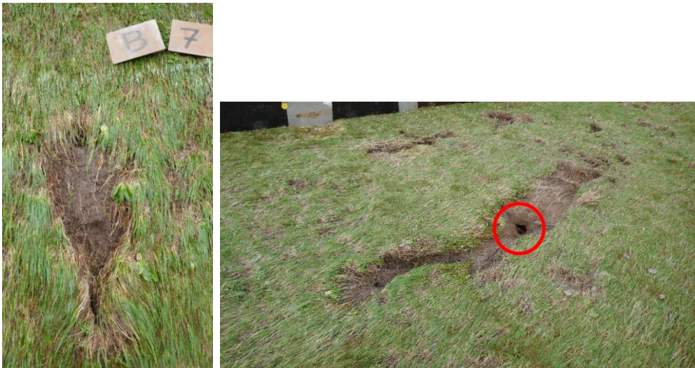
Figuur A.10 Begin schade na 2 uur GO30 (links) en doorbraak toplaag ter plaatse van de rode cirkel na 5 uur GO50 (rechts).
