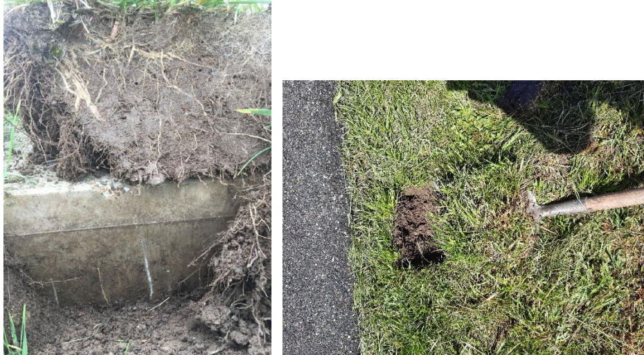
Figuur 2.4 Gestoken plag langs betonconstructie: wortelbel sluit netjes aan. Gestoken plag langs fietspad, wortelnet deels in het asfalt verankerd, plag scheurt niet langs de overgang.
