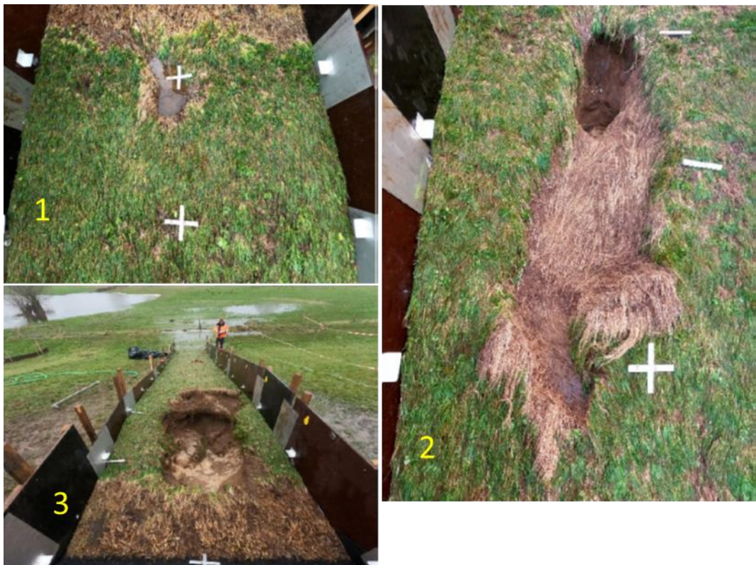
Figuur A.4 Schade (1) falen (2) en ontwikkeling van de schade na falen (3) op strook 1-2.
