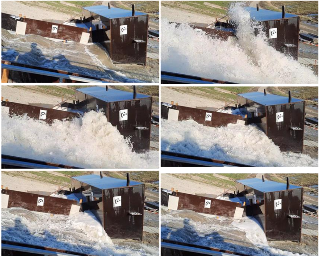
Figuur 2.9 Golfoverslag met object op verschillende momenten tijdens één golfoverslagvolume (project kalk in klei; Hedwigepolder).
