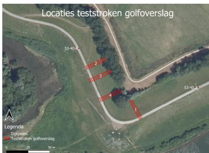
Figuur A.7 IJsseldijk locaties teststroken, betonpad op de kruin.
